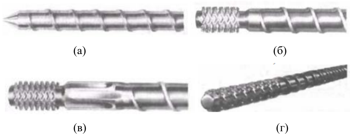
Рисунок 1.13 – Различные варианты конструкций шнеков [193]: а – с гладким наконечником, б – наконечник оснащен смесительным узлом с выступающими шипами, в – шнек, снабженный улучшенным смесительным узлом; г – смесительный узел с поперечными отверстиями на витках нарезки шнека
