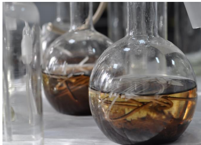
Рисунок 2.2 – Образец термопластичного крахмала в инокуляте установки Штурма
