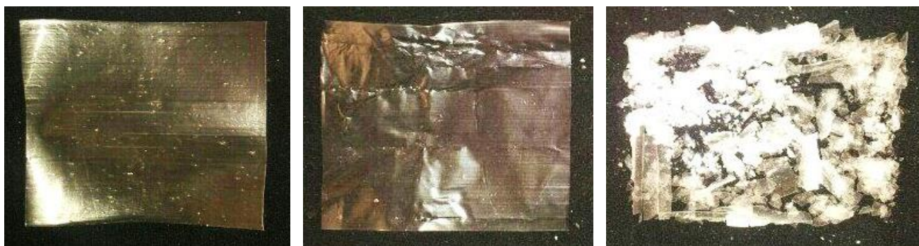
Рисунок 1.2 - Внешний вид ПКМ на основе ПЭНП/ОРД = 95/5 мас.%
