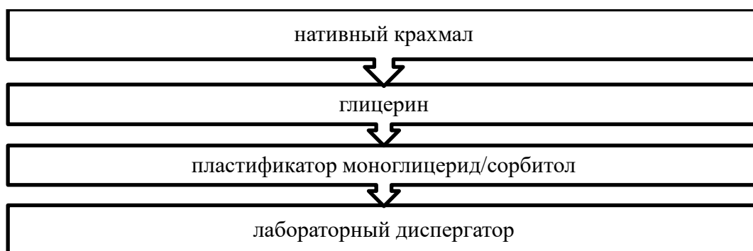
Рисунок 2.3 – Процесс изготовления термопластичного крахмала
