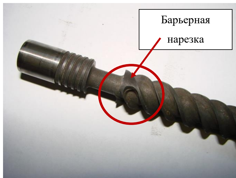
Рисунок 2.7 – Выходной элемент барьерного шнека плоскощелевого экструдера
